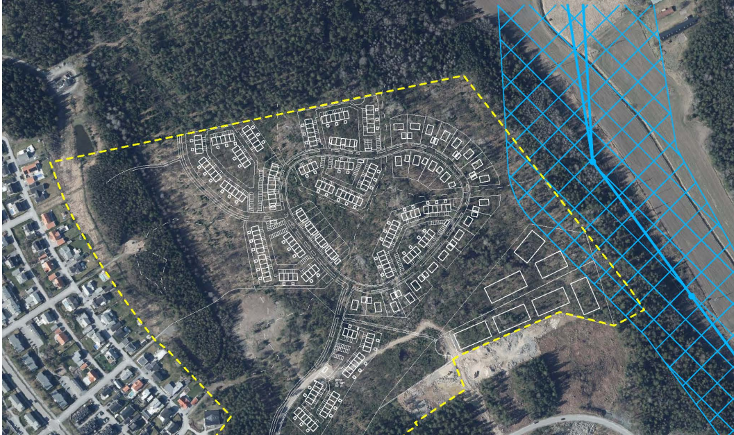
Illustration av maximal utbredning av område med magnetfält som överstiger 0,4 µT från kraftledningen (blårutigt område). Illustrerat avstånd är 120 meter och gäller vid vinkelstolpar. Från själva kraftledningen (rak sträckning) är 85 meter ett maxvärde. (Väv Arkitekter)
